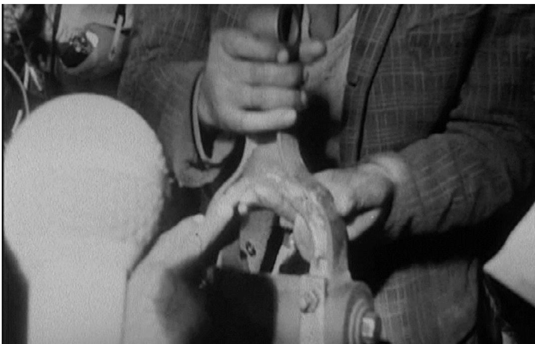
Biela para la compresión de la locomotora de ripio, hecha con dos rotas del año 1928 que ya no tienen repuesto (Guzmán, 1979).
